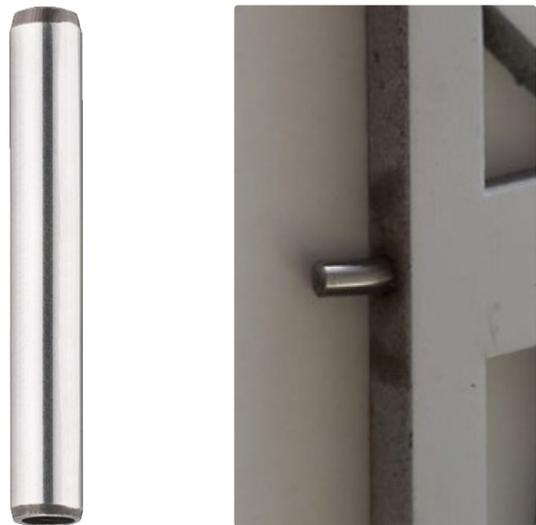
Bei mehrteiligen Elementen aus **CELLON®** können bei den Plattenstößen stirnseitig 12 mm lange **Stahlbolzen** eingebohrt werden. So wird gewährleistet, dass die Platten immer auf der gleichen Flucht sind.
