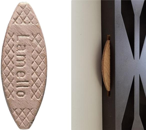
Bei mehrteiligen Elementen aus **MDF** und **EICHENSPERRHOLZ** können bei den Plattenstößen **Lamello-Verbinder** eingefräst werden. Für die Fräsungen ist pro Seite eine Einfrästiefe von 12 mm notwendig. Das Muster muss an diesen Stellen teilweise leicht angepasst werden.
